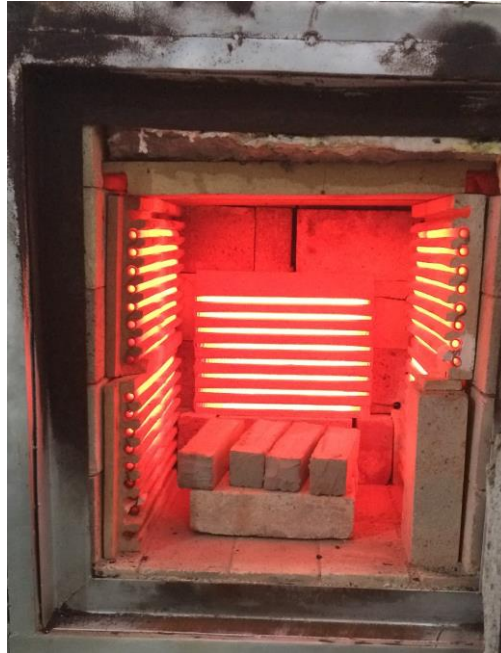
FIGURA 5 – Primeiros corpos de provas ao forno
