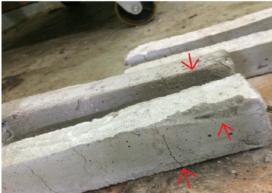
FIGURA 7 – Cp's que permaneceram expostos a 2 horas na temperatura de 900 °C
